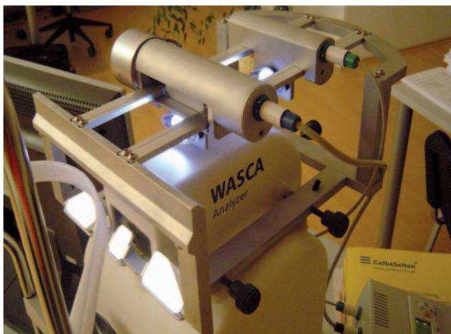
Abbildung 1: DSA-Aufsatz auf einem WASCA-Aberrometer: Mit dem Gerät ist eine Auswertung des zeitlichen Verhaltens der Wellenfront an einem akkommodierenden Auge möglich. Es stimuliert die Akkommodation synchronisiert binokular durch ein motorisch verstellbares Nah- und Fernziel.
